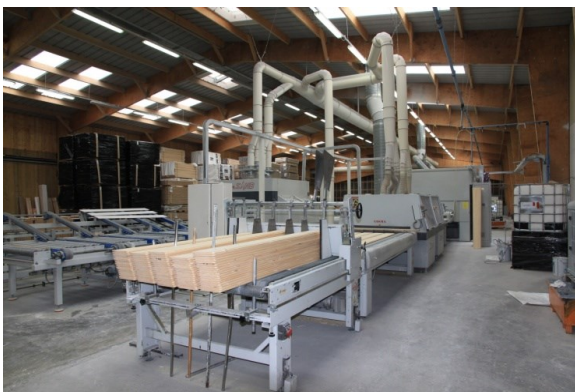
Photo 22 : Ligne de peinture
