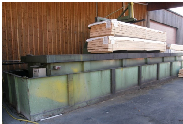
Photo 19 : Traitement par trempage (bac sous auvent extérieur)
