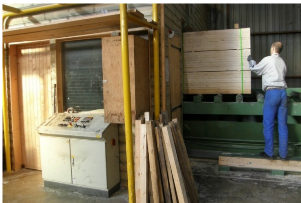
Photo 9 : Sortie tronçonneuse à paquets
