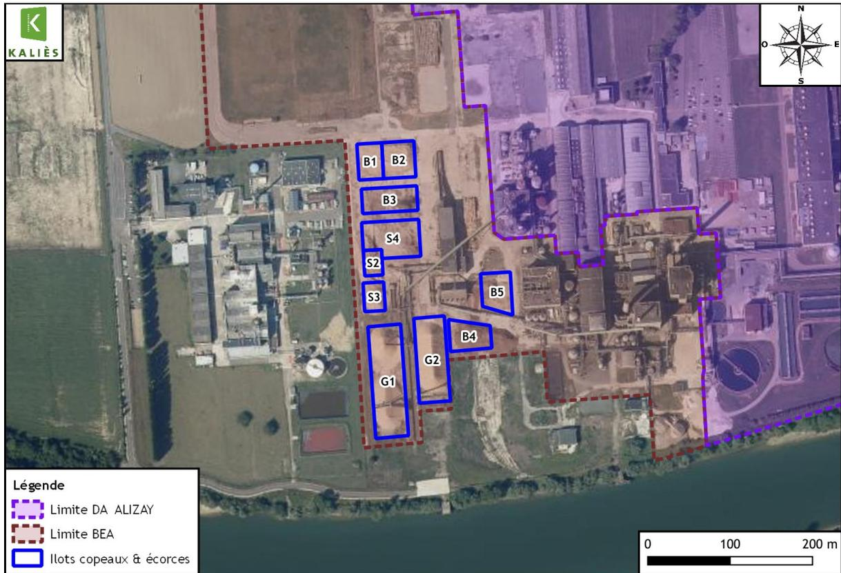
Il est à noter que la configuration de l'îlot G2 ne permet pas d'avoir un éloignement de 10 m entre le stockage et la limite du site. Le positionnement de ce stockage est en effet conditionné par les rails de guidage des gratteurs.
