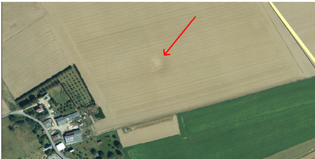
Illustration d'une dépression en photographie aérienne – extrait de la BD Ortho de l'IGN
