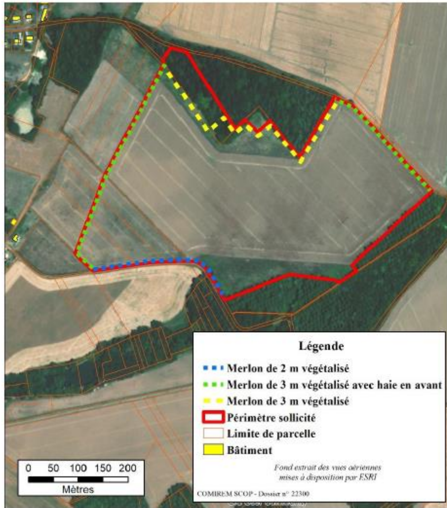
Figure 10 : Localisation et hauteur des merlons bordant le site
